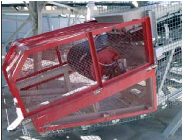
Figura 12.- Detalle de cola de cinta con cable-tirón perimétrico.
