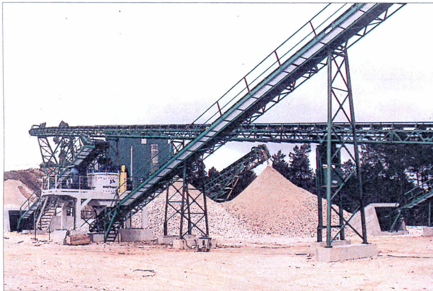
Foto 2.- Túneles de alimentación a líneas de áridos para hormigones y cuarzo mineral.
