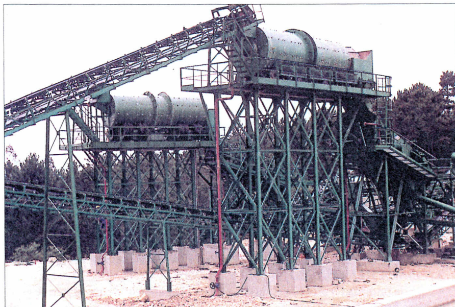
Foto 3.- Trómeles y cribas de las dos líneas existentes.
