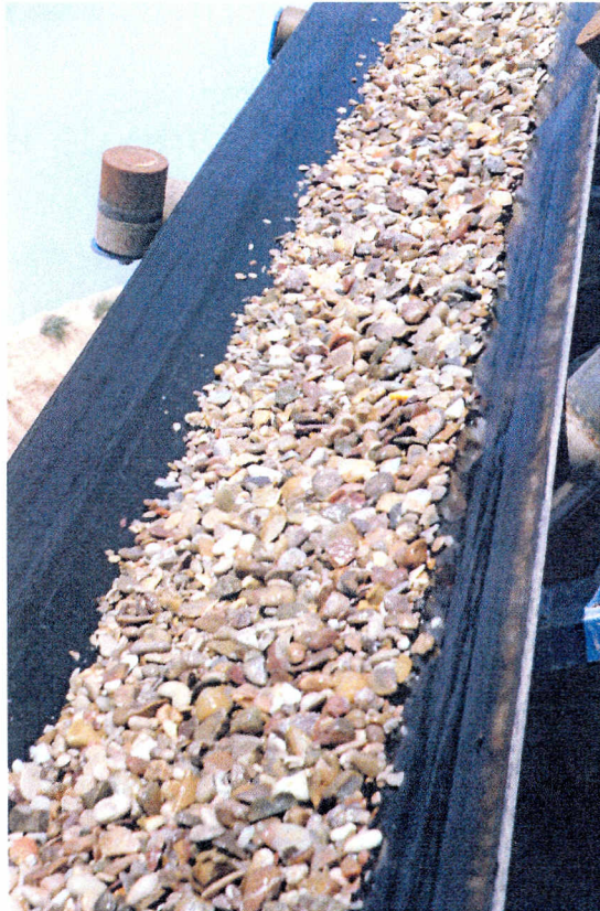
Figura 7.- Producto 6/25 mm en cinta de acopio final.
