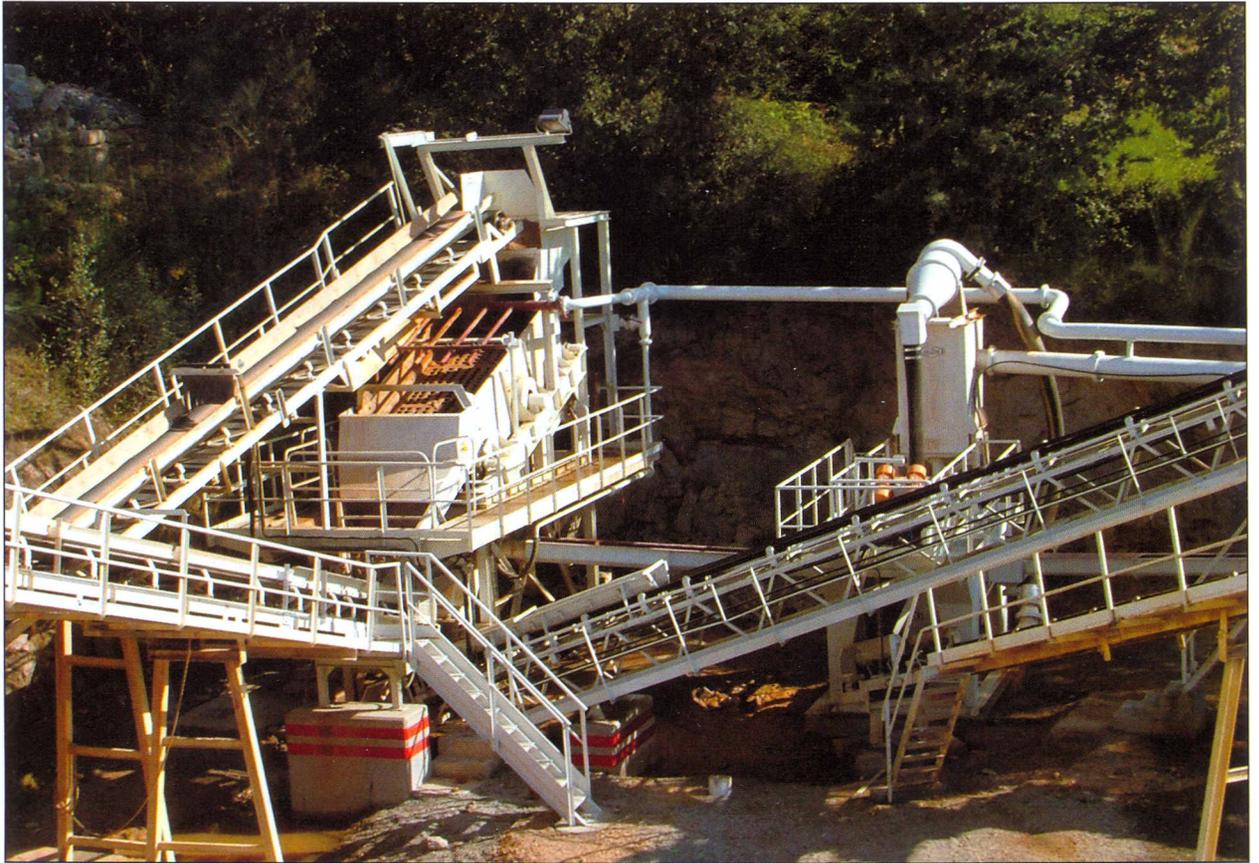
Foto 7.- Criba de estériles transformada a vía húmeda con grupo de hidrociclonado.
