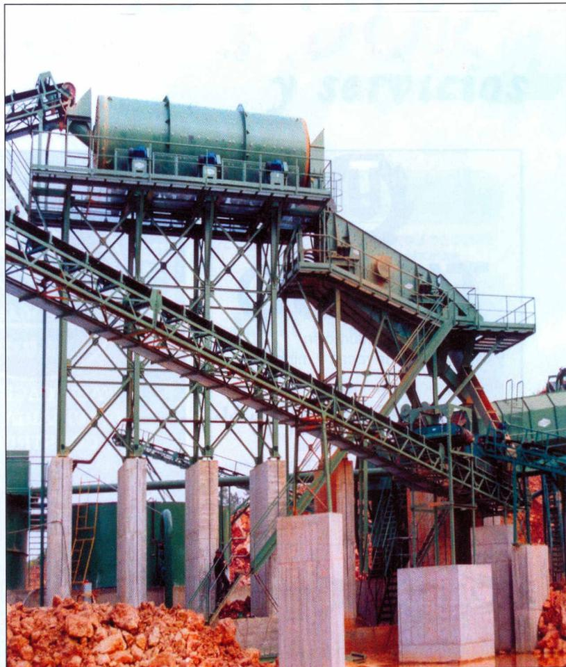
Foto 10.- Trómel, criba y lavador de piedras en cascada
